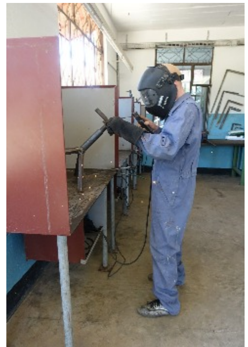
Charles schweisst an einem der 4 Arbeitsplätze mit einer Schweissanlage.
